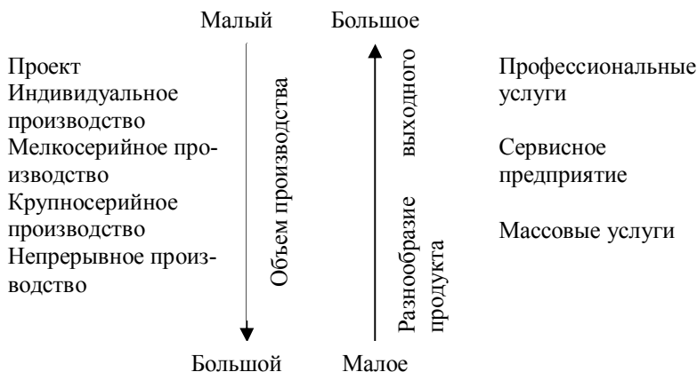
Р и с . 8 . 2 . Взаимосвязь типов процесса с объемом производства и разнообразием продукта
