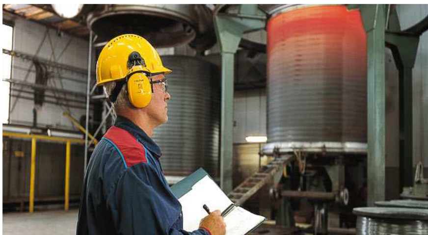
Рис.16.2. Использование противошумных наушников в зоне работы шумоактивного оборудования
