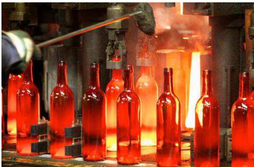
Рис.5.3 Производство стеклотары прессовыдувным способом
