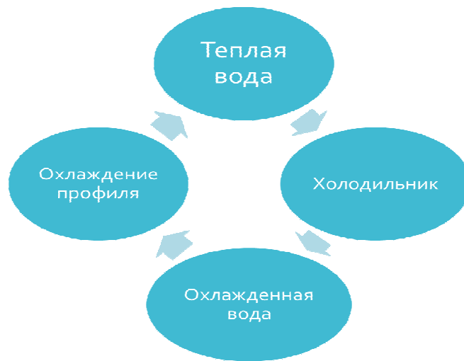
Рис. 14.6. Организация оборотных циклов технологической воды
