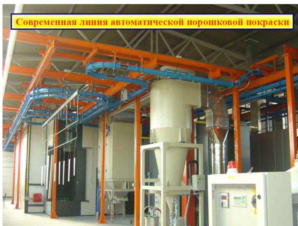
Рис. 13.1 Общий вид установки порошкового окрашивания
