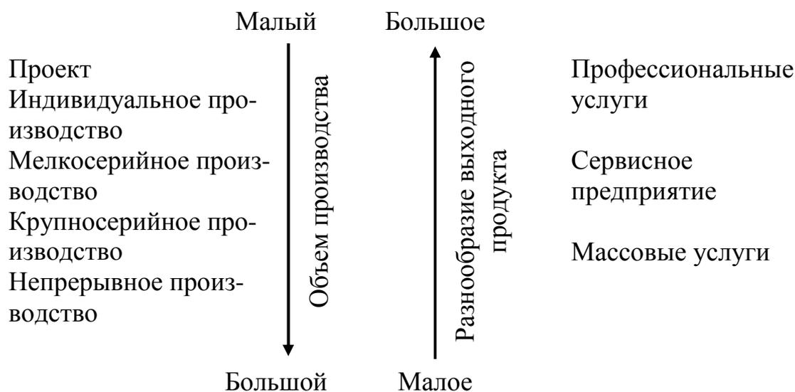
Рис. 25. Взаимосвязь типов процесса с объемом производства и разнообразием продукта
