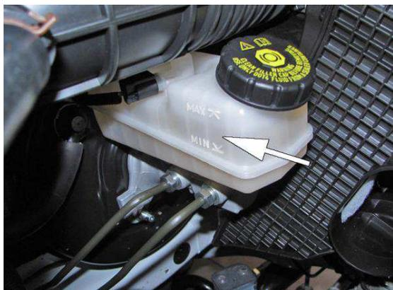
*Рис.4.19.* Проверка уровня тормозной жидкости
