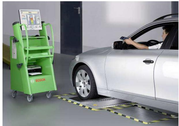
Рис.1.4. Проверка эффективности торможения на стенде
