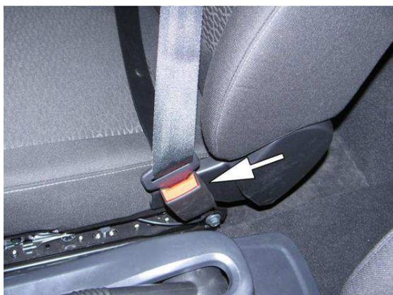
*Рис.4.15.* Проверка работы замка ремня безопасности
