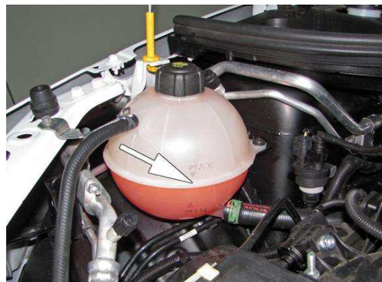
*Рис.4.20.* Проверка уровня охлаждающей жидкости
