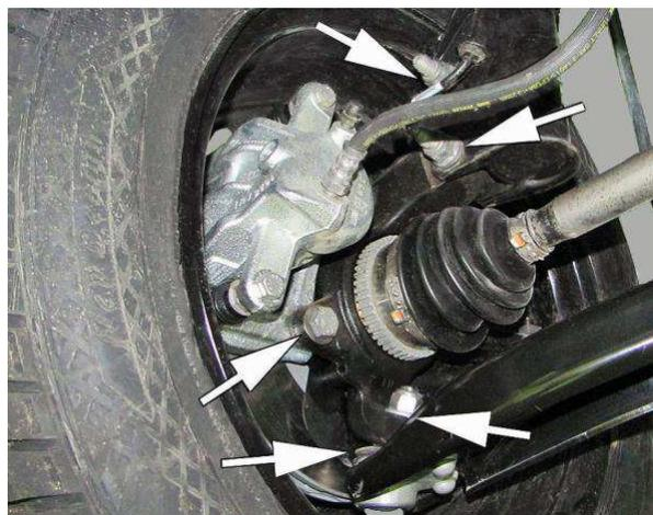
*Рис.4.5.* Проверка состояния деталей передней подвески
