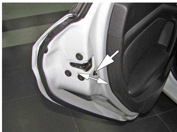
*Рис.4.14.* Проверка работы рычага задней двери ("детский замок")
