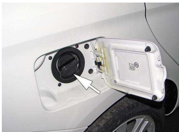
*Рис.4.13.* Проверка крышки люка топливного бака и надёжности фиксации пробки горловины топливного бака
