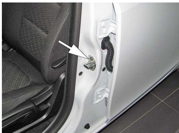
Рис.4.11. Регулировка замка передней двери
