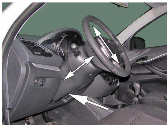
*Рис.4.16.* Проверка перемещения рулевого колеса по высоте и вдоль рулевой колонки
