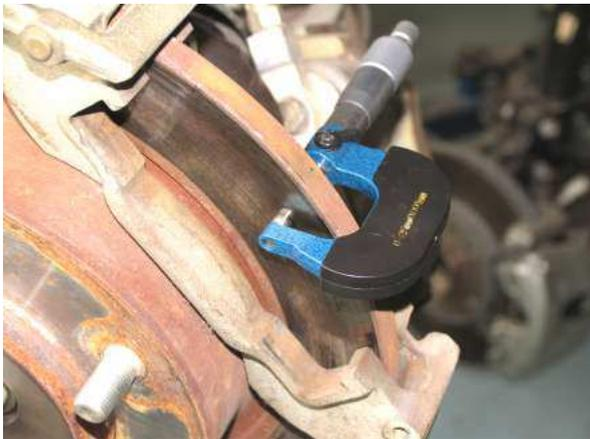
Рис.1.3. Измерение толщины тормозного диска
