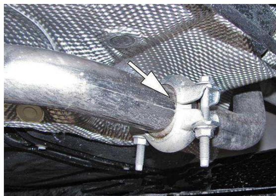
*Рис.4.10.* Проверка герметичности системы выпуска ОГ
