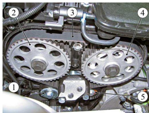
*Рис.4.28.* Замена деталей ГРМ на двигателе ВАЗ-21129:
