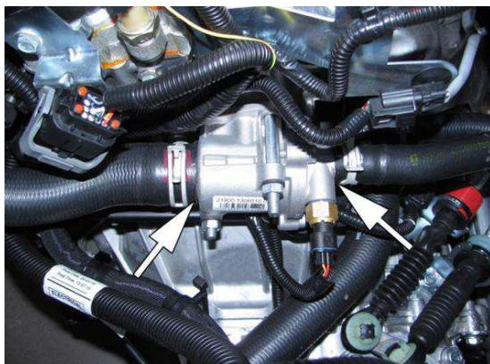
Рис.4.17. Проверка герметичности системы охлаждения
