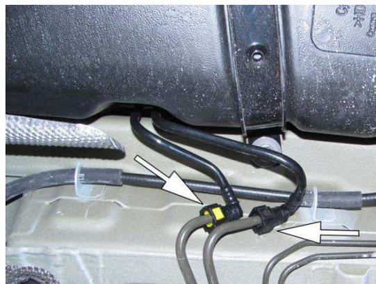
Рис.4.18. Проверка герметичности системы питания
