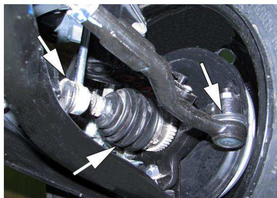
*Рис.4.8.* Проверка состояния шарниров рулевых тяг, приводов колёс, шаровых пальцев
