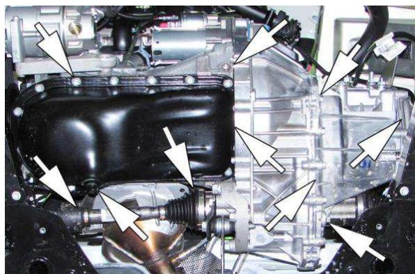
*Рис.4.9.* Проверка герметичности уплотнений узлов и агрегатов
