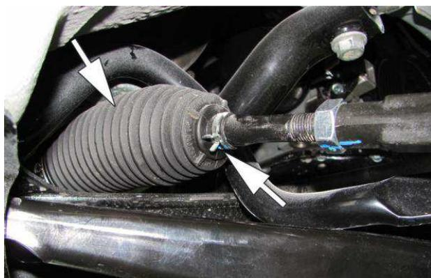
*Рис.4.7.* Проверка состояния защитных чехлов рулевого механизма
