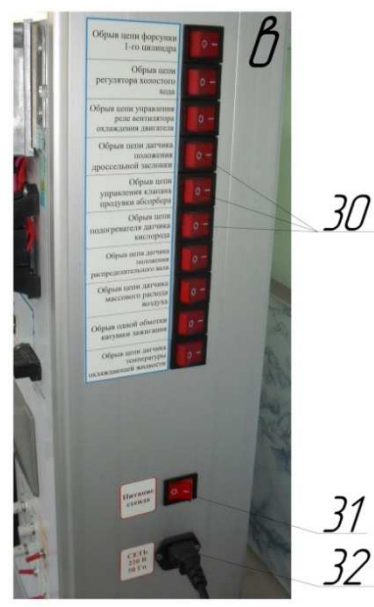
Рис. 2.1. Внешний вид лабораторного стенда-тренажёра «Система управления инжекторного двигателя ВАЗ-1118»:
