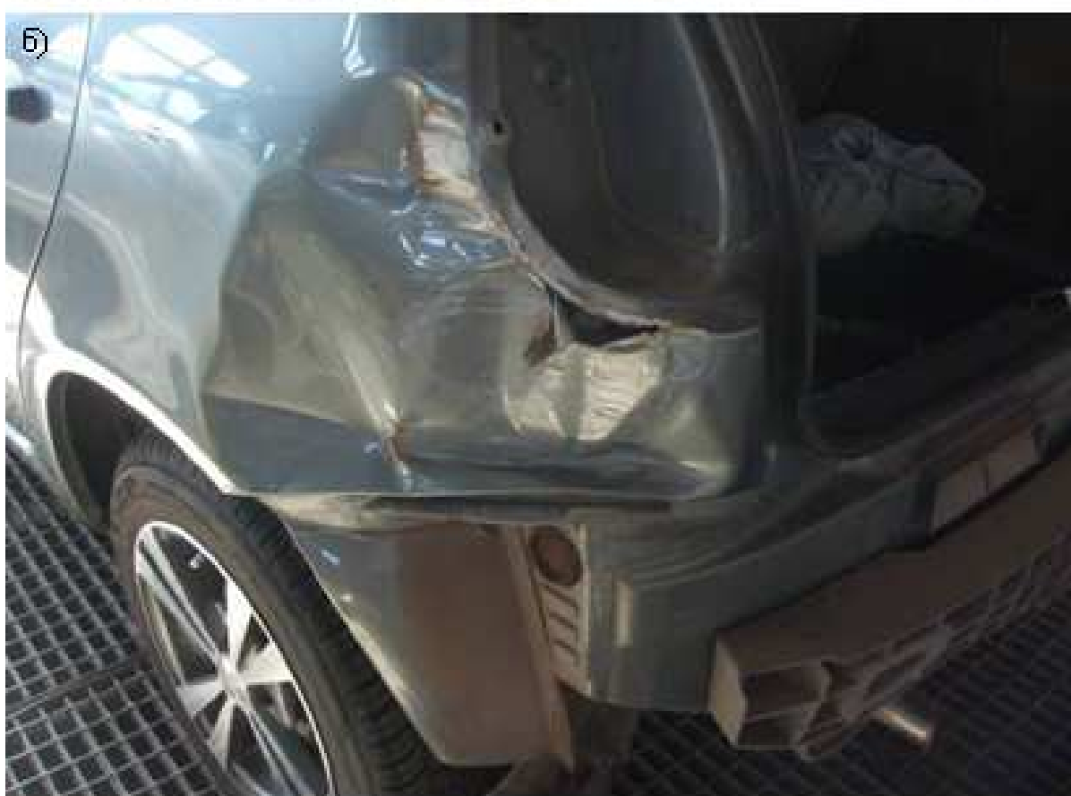
Рис.4.17. Повреждения автомобиля LADA-11193: а) фонарь задний левый, бампер задний; б) крыло заднее левое
