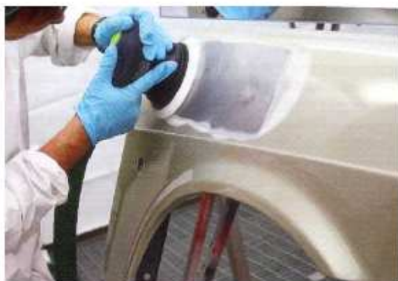
Рис.1.34. Подготовка поверхности при помощи шлифмашинки Festool
