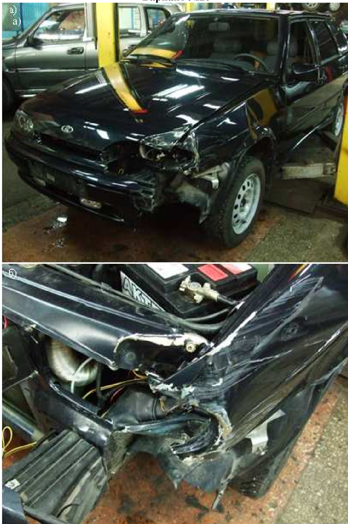
Рис.4.21. Повреждения автомобиля LADA-21144: а) внешний вид автомобиля; б) крыло переднее левое, рамка радиатора, бампер передний, блок-фара левая
