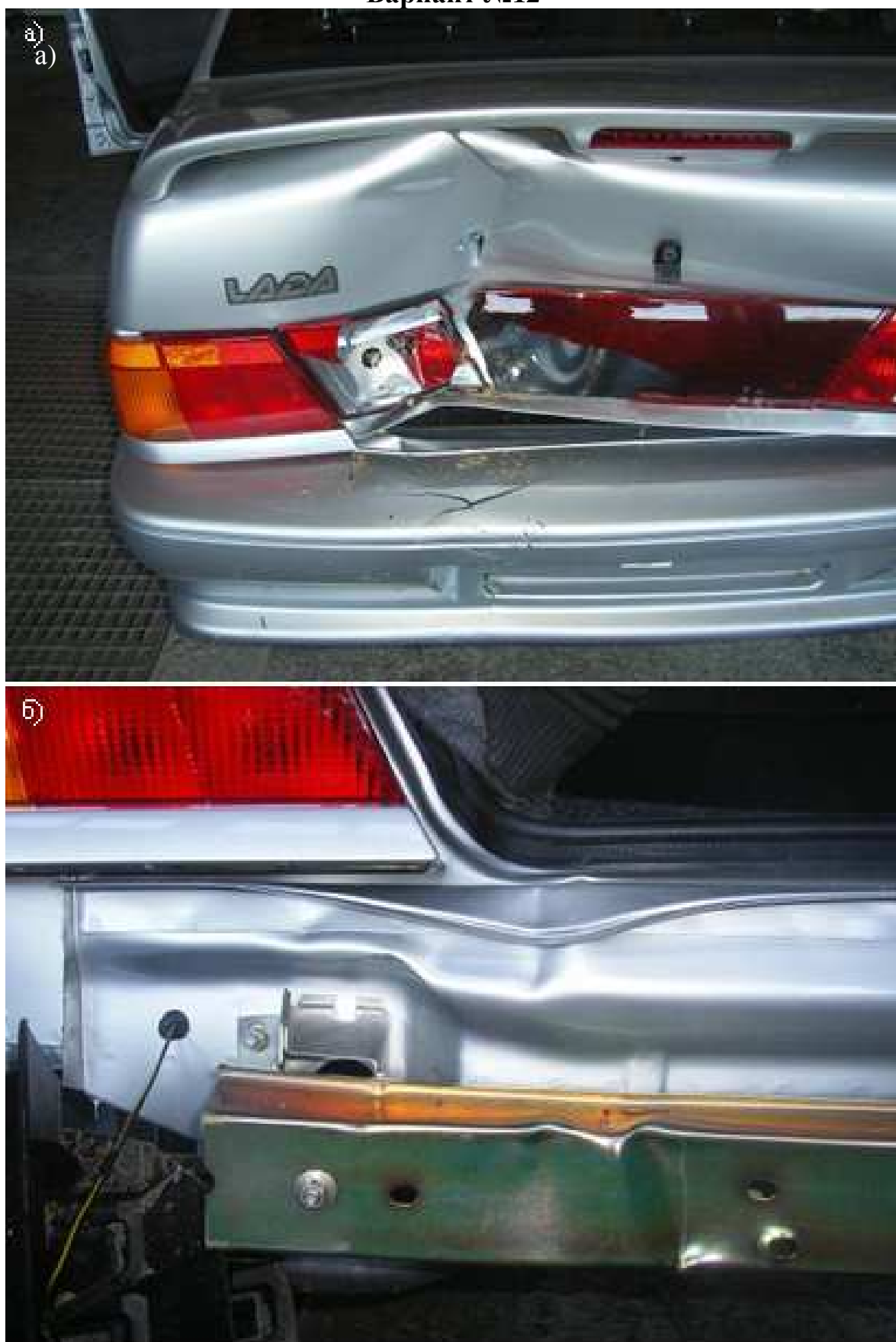
Рис.4.13. Повреждения автомобиля LADA-21154: а) внешний вид автомобиля; б) панель задка, бампер задний, балка заднего бампера
