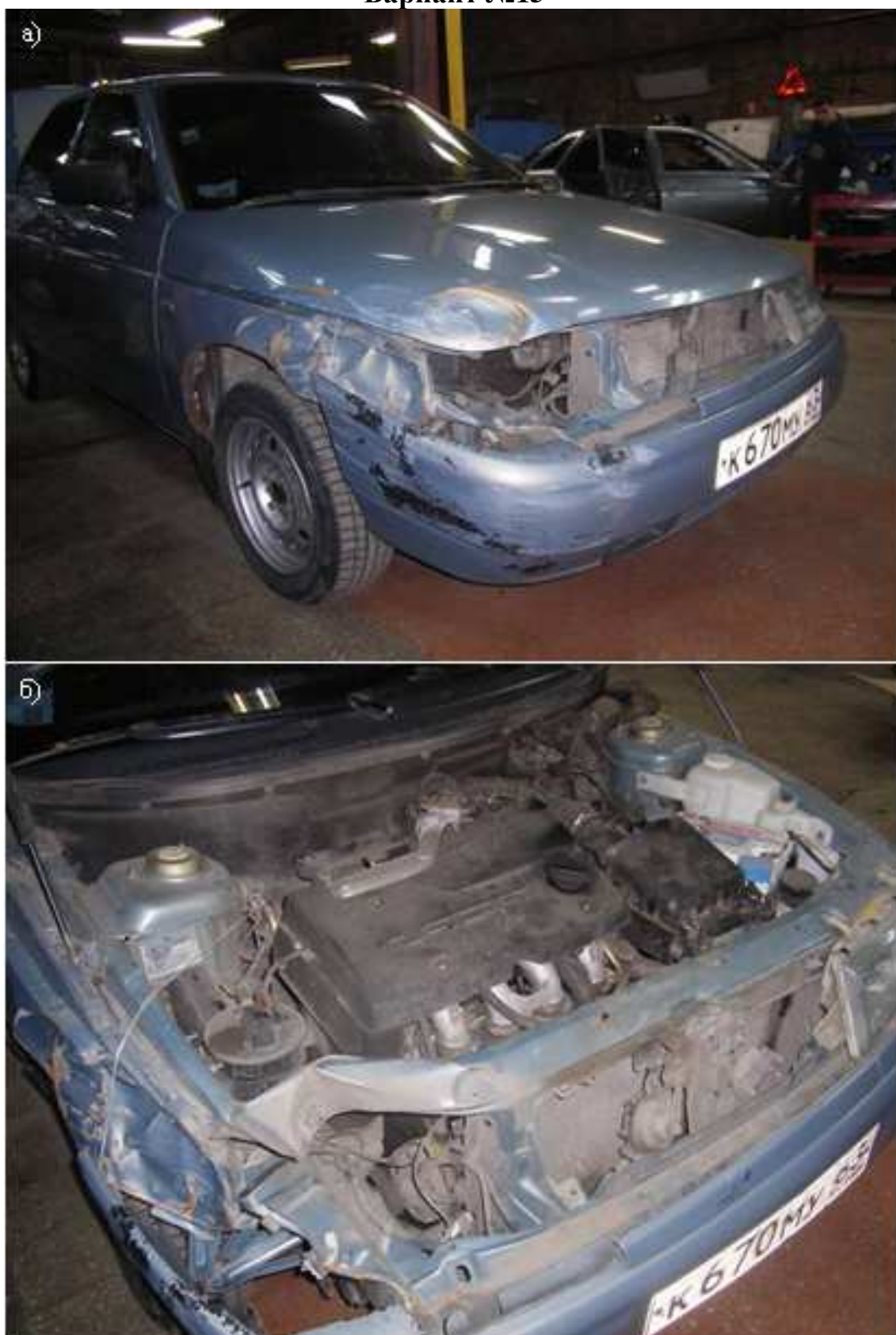
Рис.4.16. Повреждения автомобиля LADA-21103: а) внешний вид автомобиля; б) крыло переднее правое, поперечина верхняя рамки радиатора
