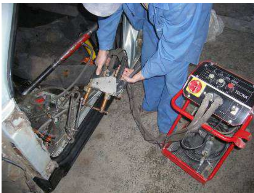
Рис.1.18. Частичная замена боковины (порога) автомобиля LADA SAMARA
