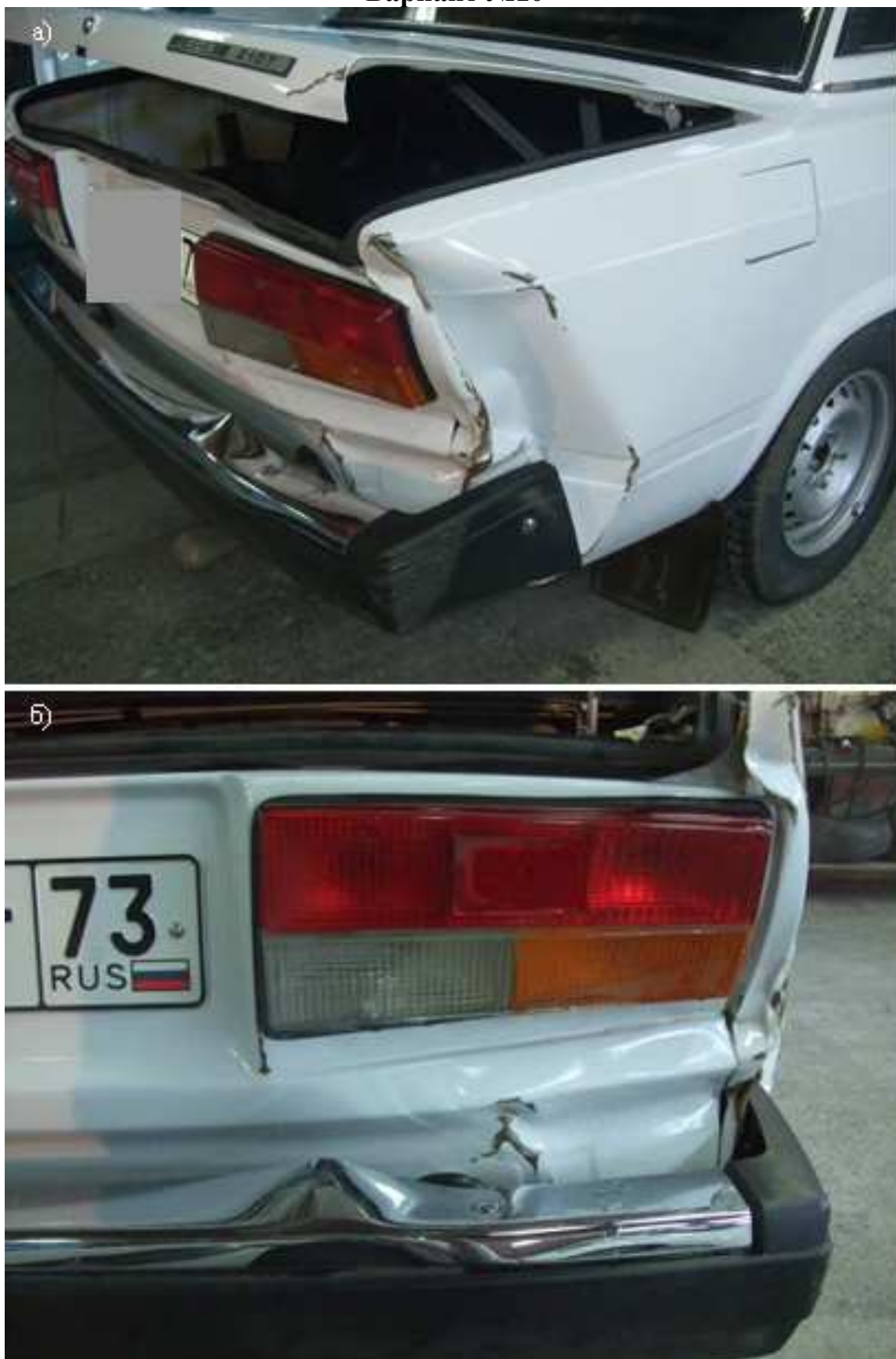
Рис.4.11. Повреждения автомобиля LADA-21074: а) крыло заднее правое, крышка багажника; б) панель задка, бампер задний, фонарь задний правый
