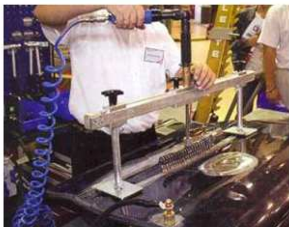
Рис.1.24. Устранение вмятины с помощью стойки-траверсы
