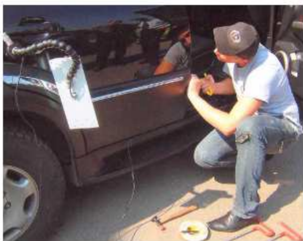
Рис.1.29. Использование лампы при устранении вмятины
