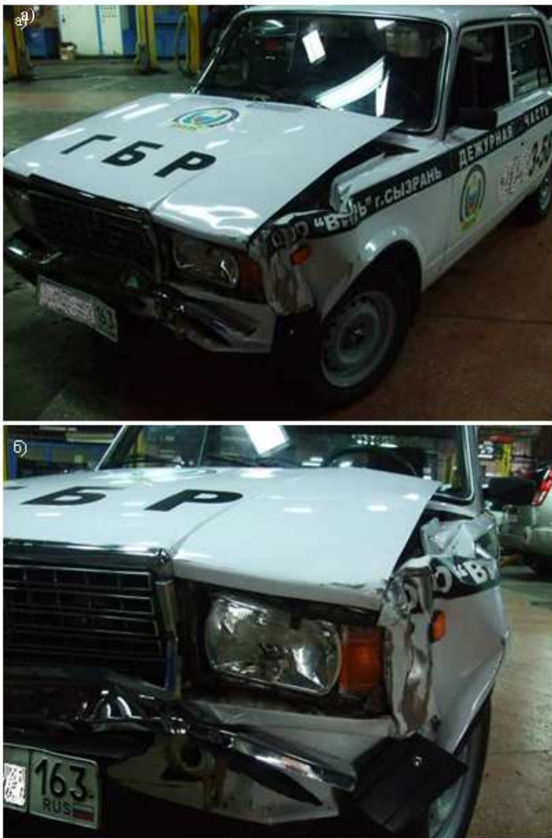
Рис.4.3. Повреждения автомобиля LADA-21074: а) внешний вид автомобиля; б) крыло переднее левое, панель передка, капот, бампер передний, блок-фара
