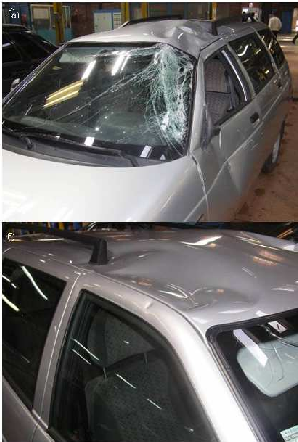
Рис.4.4. Повреждения автомобиля LADA-21113: а) внешний вид автомобиля; б) панель крыши, дверь передняя правая, стекло ветрового окна
