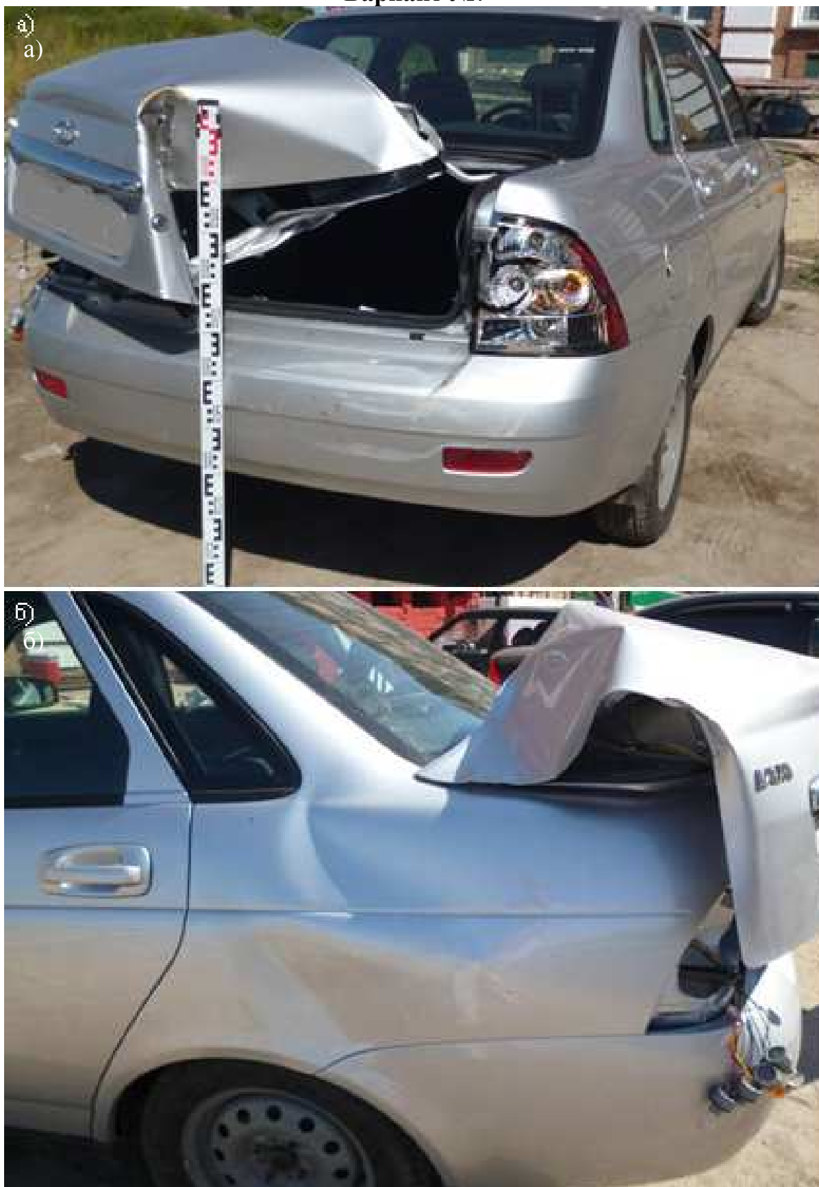
Рис.4.8. Повреждения автомобиля LADA-21703: а) внешний вид автомобиля; б) крыло заднее левое, фонари задние левый и правый, крышка багажника
