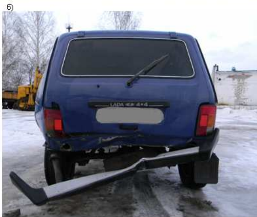
Рис.4.5. Повреждения автомобиля LADA-21214: а) внешний вид автомобиля; б) дверь задка, панель задка, бампер задний, фонарь задний левый
