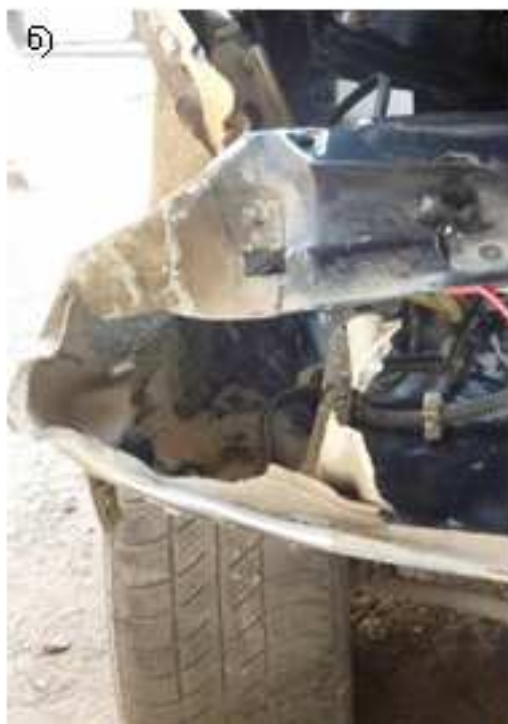
Рис.4.15. Повреждения автомобиля LADA-21144: а) внешний вид автомобиля; б) рамка радиатора; в) брызговик крыла переднего правый
