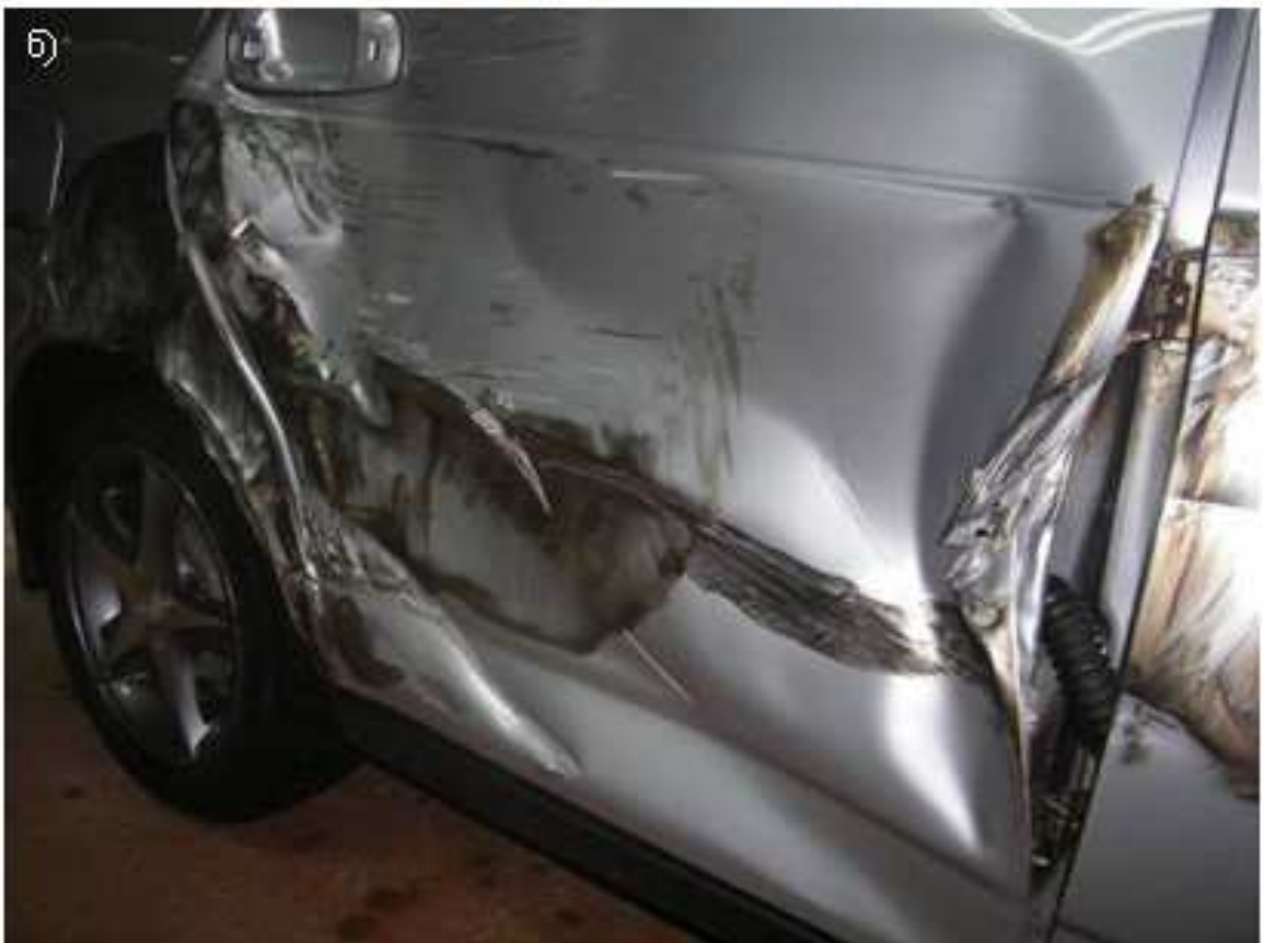
Рис.4.13. Повреждения автомобиля LADA-21723: а) внешний вид автомобиля; б) дверь и крыло задние правые, стойка центральная правая
