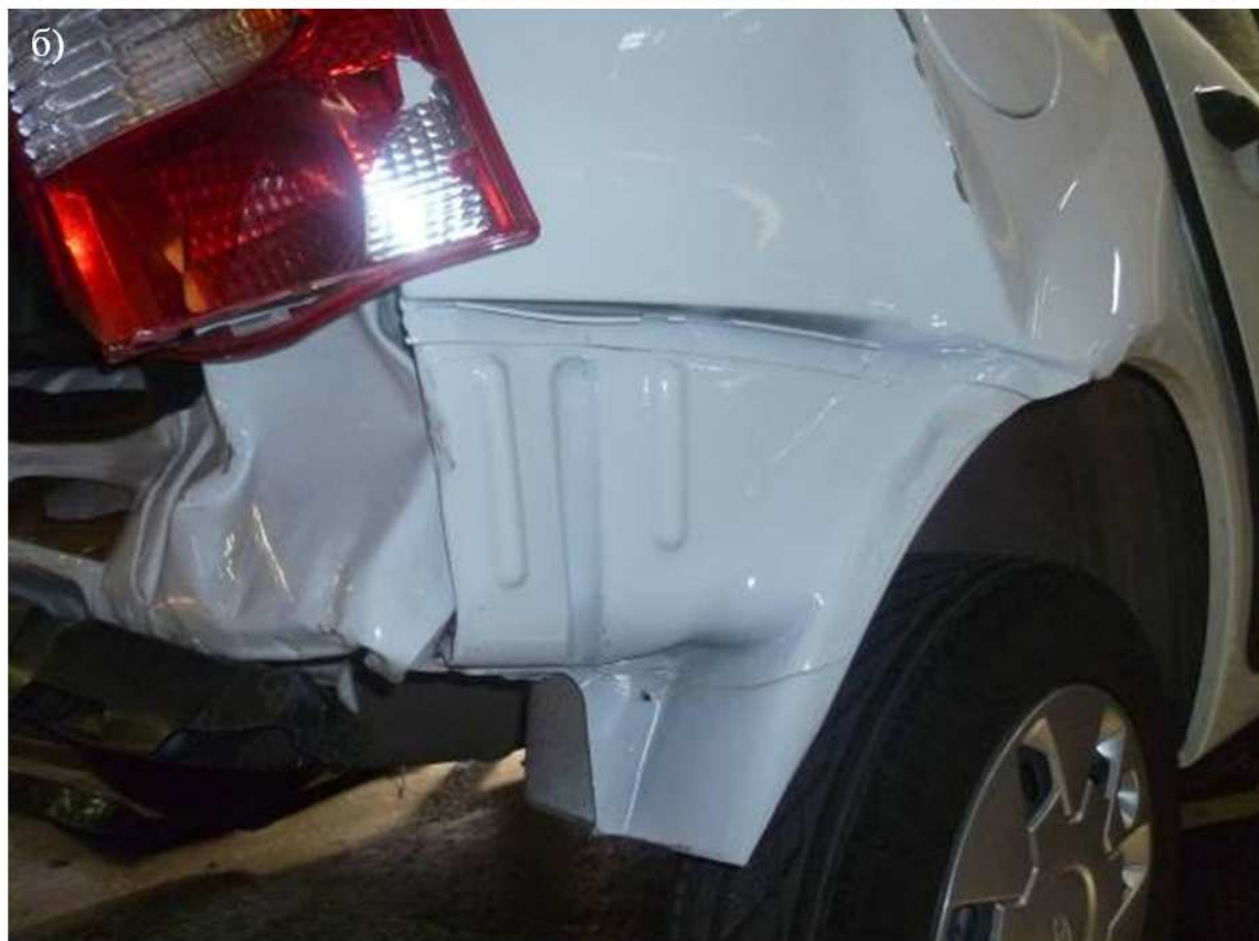
Рис.4.2. Повреждения автомобиля LADA-11173: а) внешний вид автомобиля, б) крыло заднее правое, панель задняя, фонарь задний правый
