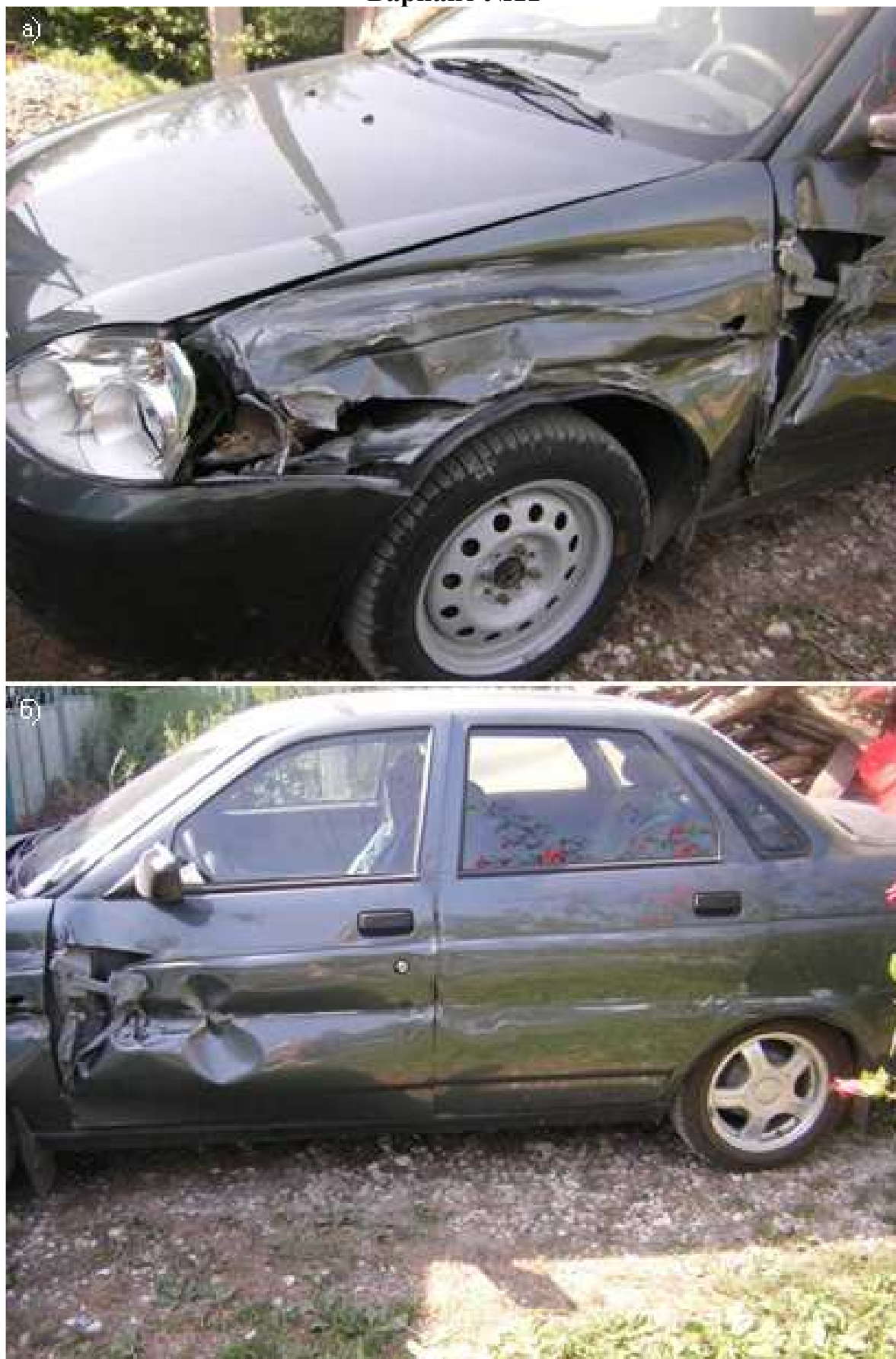
Рис.4.12. Повреждения автомобиля LADA-21703: а) крыло переднее левое, блок-фара левая; б) двери передняя и задняя левые, крыло заднее левое
