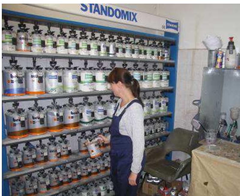
Рис.1.31. Миксерная установка базисных эмалей
