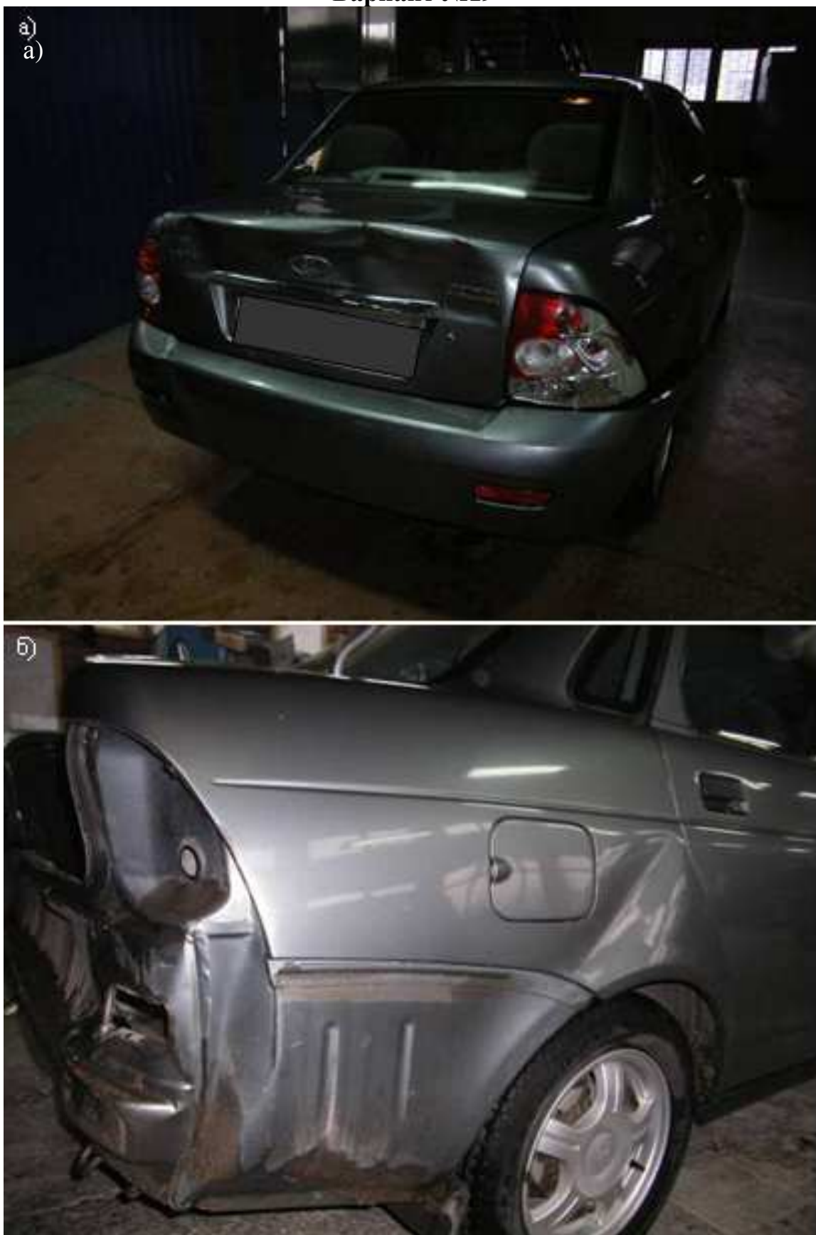
Рис.4.20. Повреждения автомобиля LADA-21703: а) внешний вид автомобиля; б) крыло заднее правое, панель задка в сборе
