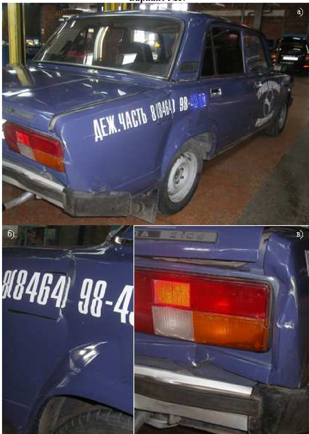
Рис.4.18. Повреждения автомобиля LADA-21054: а) внешний вид автомобиля; б) крыло заднее правое; в) панель задка, бампер задний, фонарь задний правый
