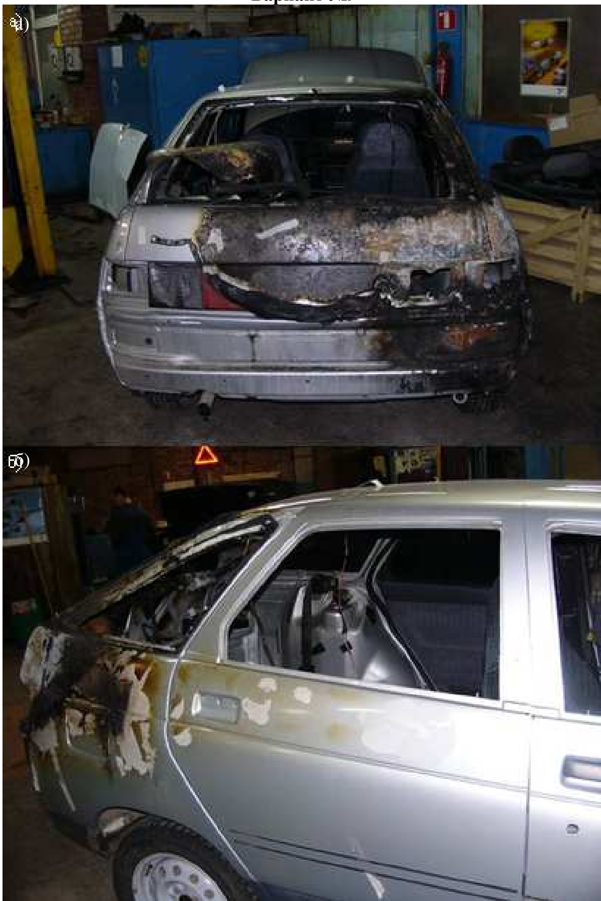
Рис.4.10. Повреждения автомобиля LADA-21123: а) крышка багажника, панель задка; б) крыло заднее правое, дверь задняя правая, стекло окна боковины
