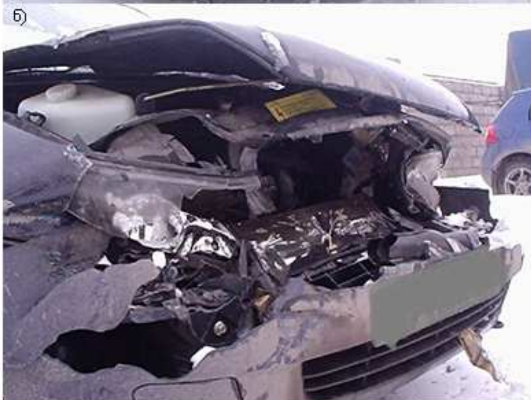
Рис.4.7. Повреждения автомобиля LADA-11183: а) внешний вид автомобиля; б) крылья передние правое и левое, капот, рамка радиатора; блок-фары
