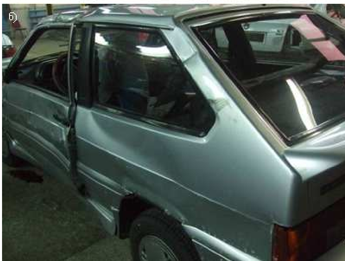
Рис.4.9. Повреждения автомобиля LADA-21134: а) дверь и крыло передние левые; б) боковина левая, панель крыши, обтекатели порога левого
