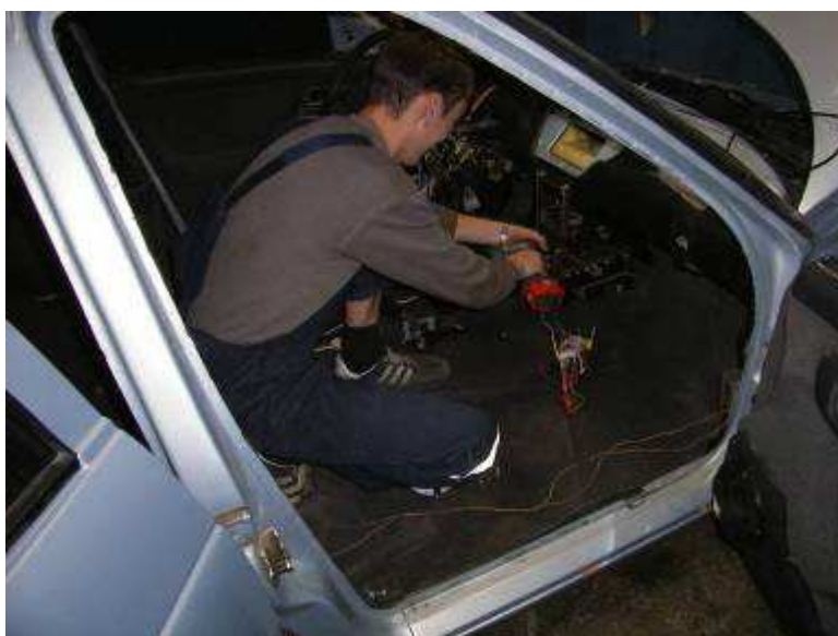
Рис.1.4. Демонтаж панели приборов на автомобиле LADA PRIORA для устранения сложного перекоса кузова
