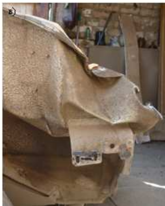
Рис.4.15. Повреждения автомобиля LADA-21144: а) внешний вид автомобиля; б) рамка радиатора; в) брызговик крыла переднего правый
