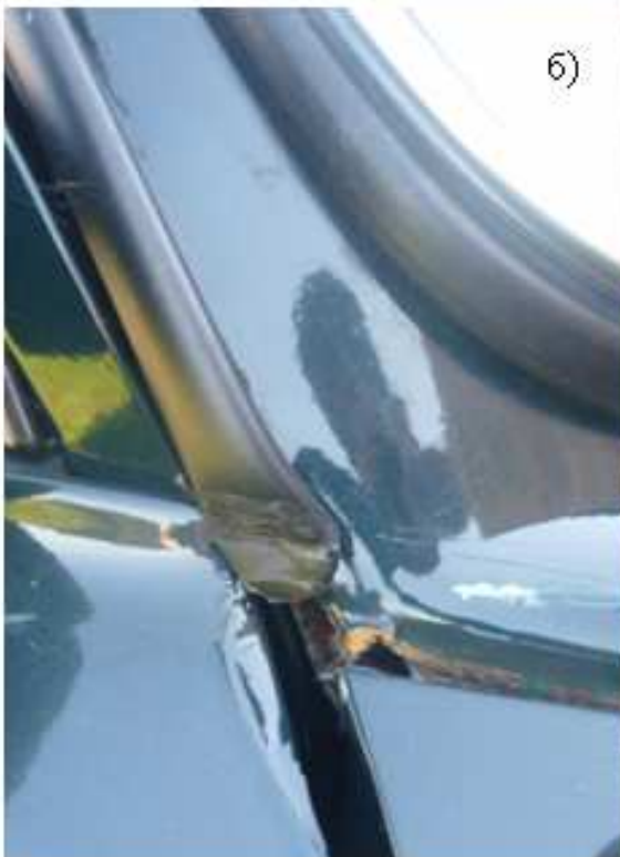
Рис.4.1. Повреждения автомобиля LADA-21074: а) переднее правое крыло, дверь и боковина; б) рамка ветрового окна; в) панель крыши
