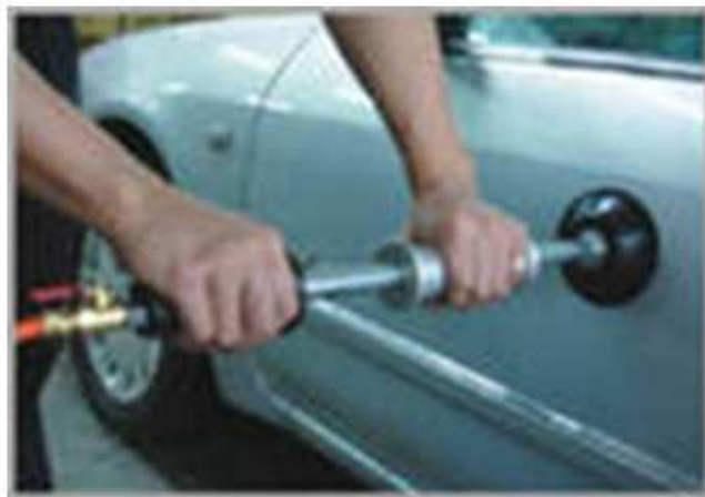
Рис.1.25. Устранение вмятины обратным молотком с вакуумной присоской
