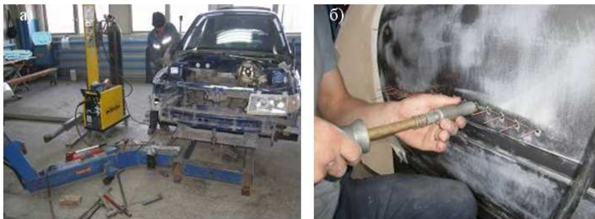
Рис.1.5. Участок ремонта кузовов автомобилей: а - устранение среднего перекоса кузова на кузовном стенде; устранение вмятины обратным молотом
