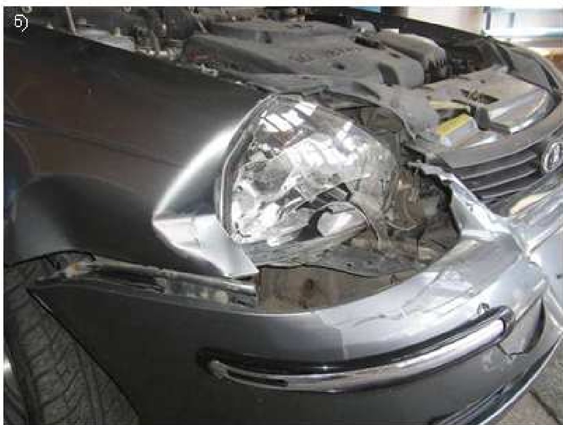
Рис.4.6. Повреждения автомобиля LADA-21703: а) внешний вид автомобиля; б) крыло переднее правое, блок-фара правая, бампер передний
