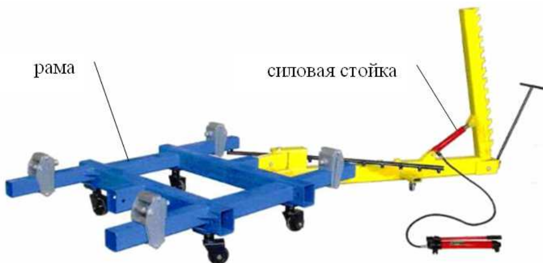
Рис.1.12. Универсальный стенд для устранения перекосов кузова
