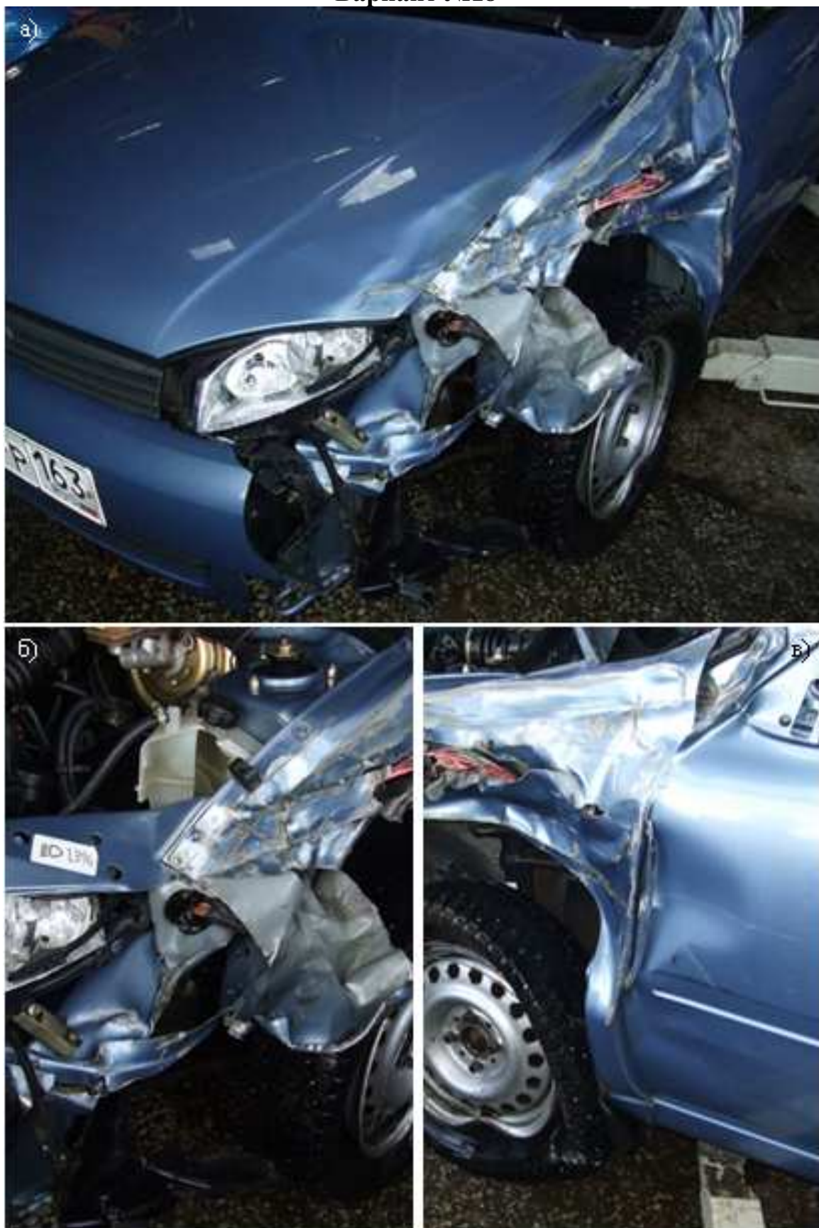
Рис.4.19. Повреждения автомобиля LADA-11183: а) внешний вид автомобиля; б) крыло переднее левое, рамка радиатора; в) диск, шина, дверь передняя левая
