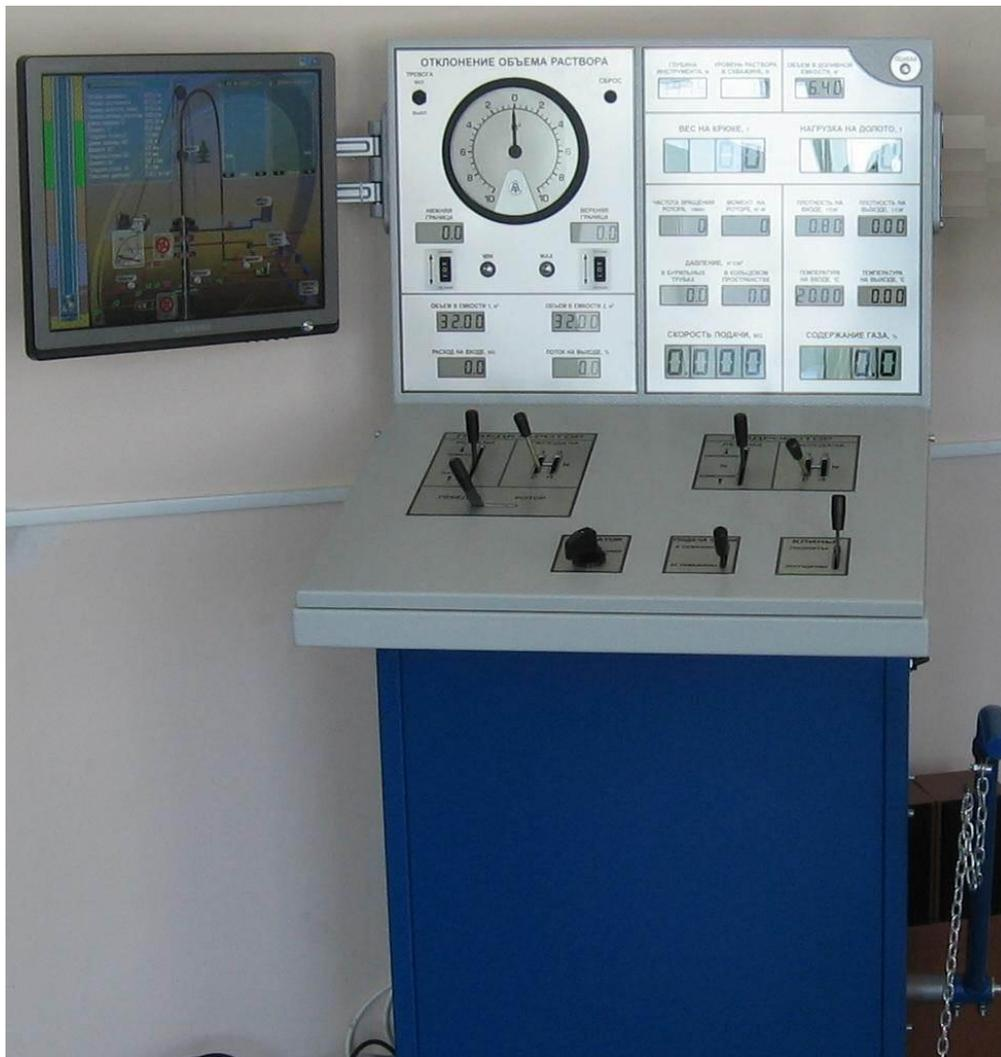
Рисунок 5. Тренажер-имитатор капитального ремонта скважин АМТ-411
