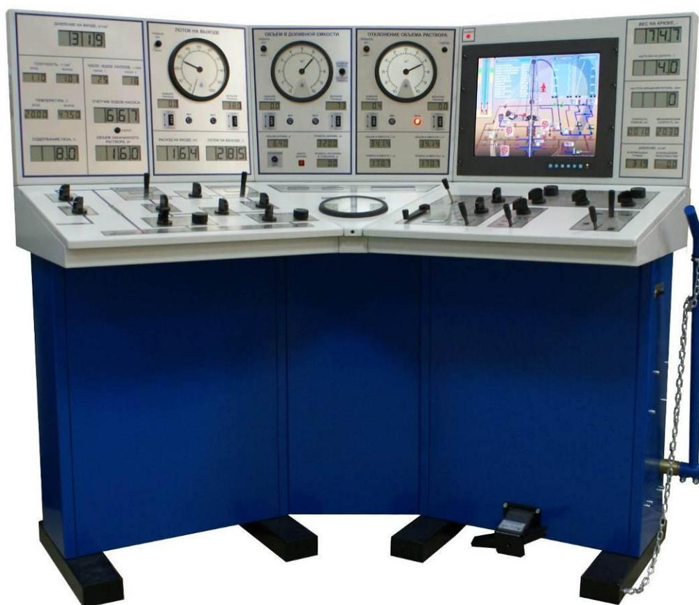
Рисунок 2. Тренажер-имитатор бурения АМТ-231
