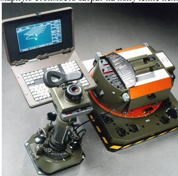
Рисунок 8. Аэрофотокомплекс, интегрированный с GPS-приемником
